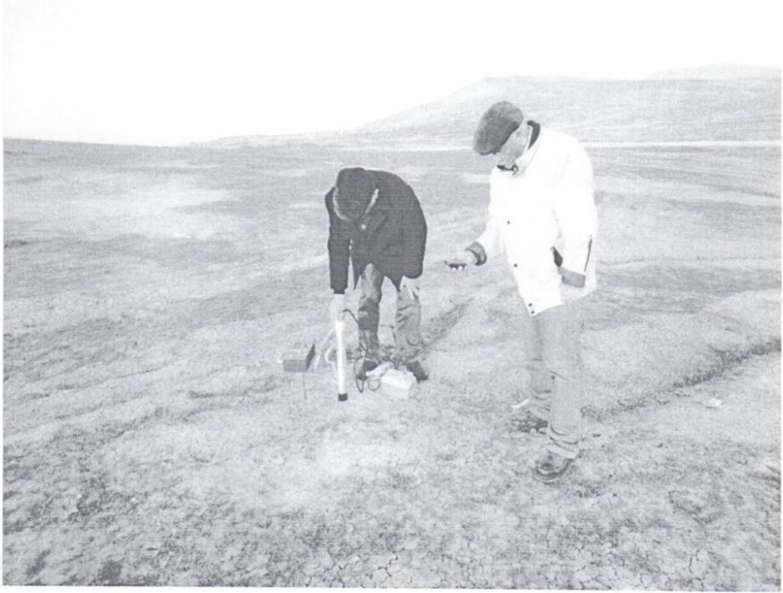
Şəkil 7. Ç.S.Əliyev və Ə.Ə.Feyzullayev Qobustan rayonunun ərazisində Markus-10 cihazının köməyi ilə torpaqda radonun qatılığını və СРП-68 cihazının köməyi ilə təbii radiasiya fonunu təyin edirlər
