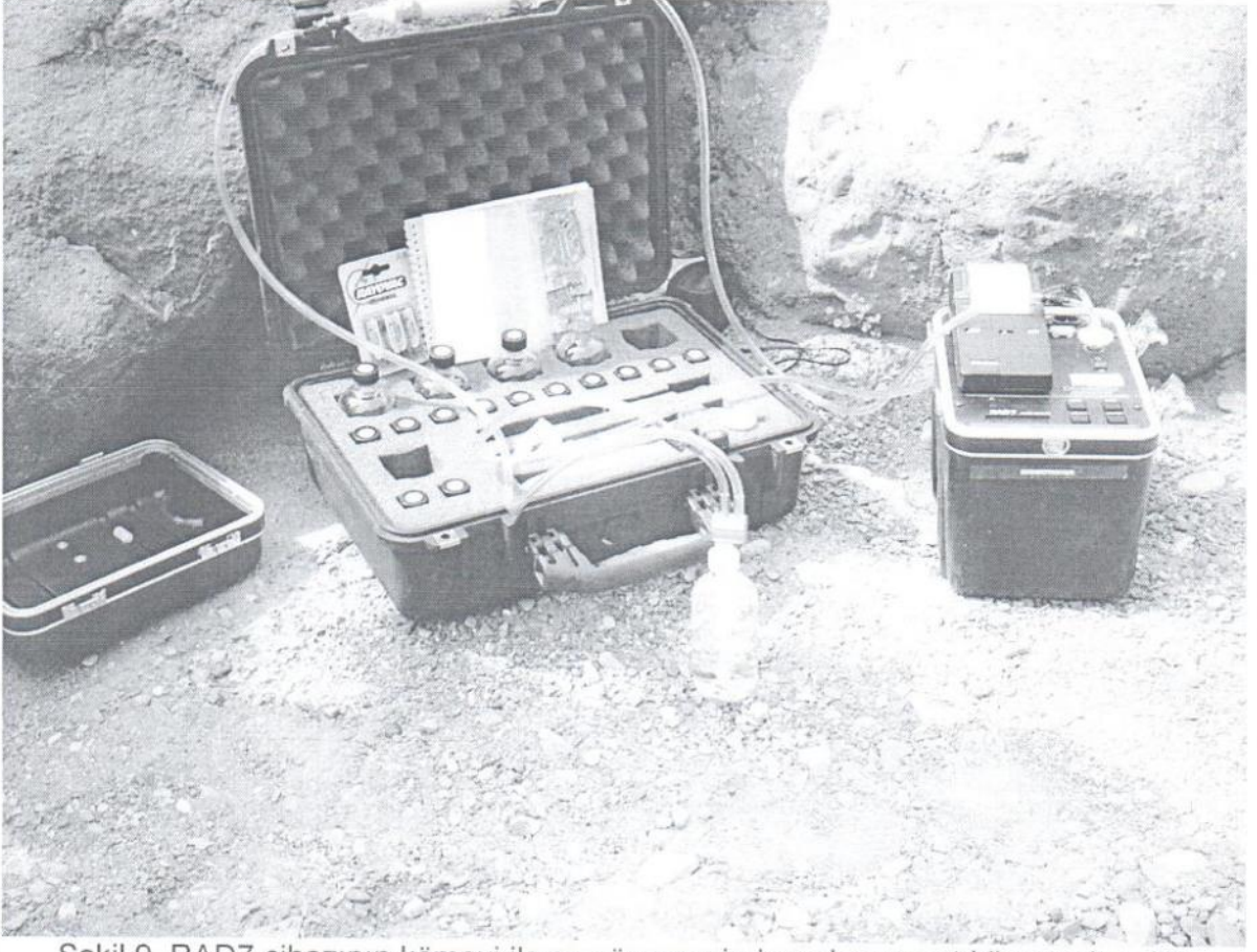
Şekil 9. RAD7 cihazının kömüğü ile su nümunesinde radonun qatılıđını teyin edilir
