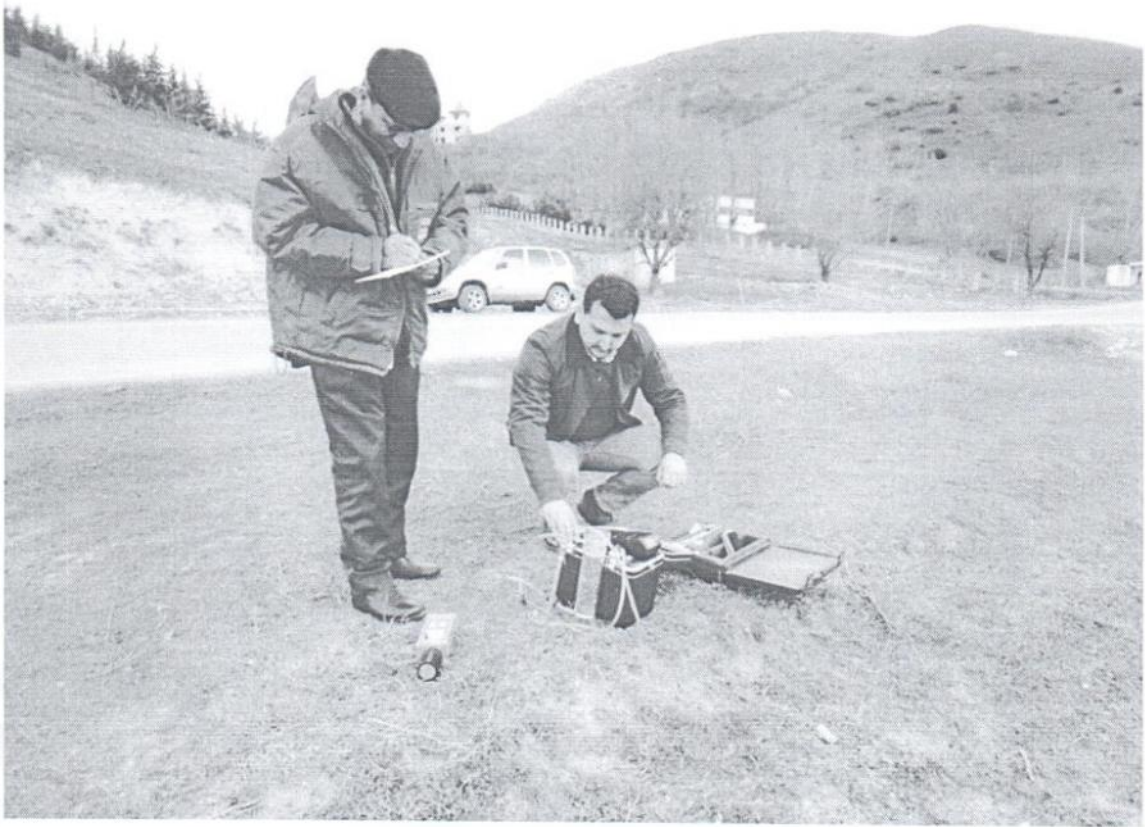
Şəkil 8. Ç.S.Əliyev və E.S.Hüseynov Şamaxı rayonunun ərazisində RAD7 cihazının köməyi ilə torpaqda radonun qatılığı və MKC-AT1125 cihazının köməyi ilə təbii radiasiya fonunu təyin edirlər
