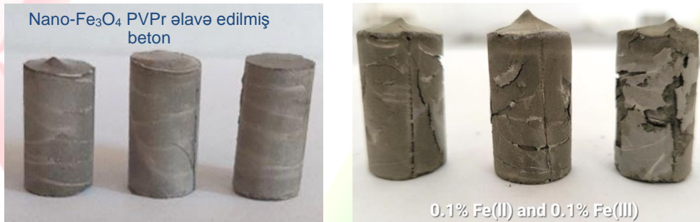
Şəkil 6. Maqnetit nanohissəcikli PVP və Fe^{2+}/Fe^{3+} duzları doldurulmuş beton nümunələri. 28 günlük sərtləşmədən sonra
