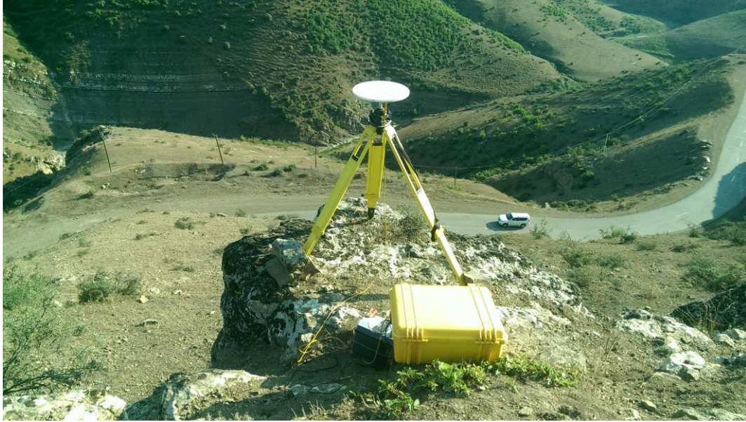
Şəkil 2.1. Azərbaycan GPS şəbəkəsinə daxil olan Yardımlı (YARD) müşahidə məntəqəsində çöl ölçü işləri.
