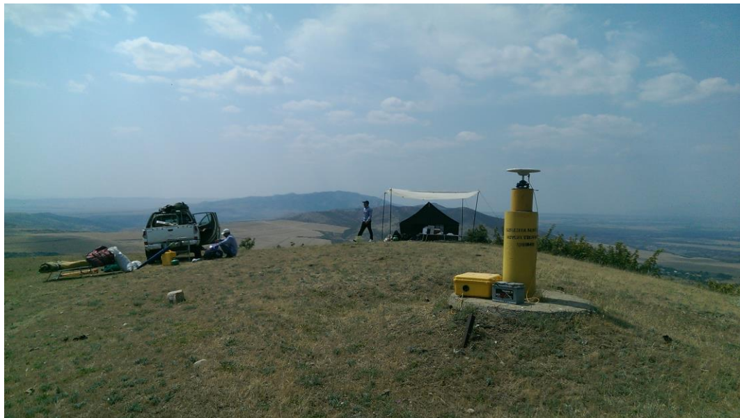
Şəkil 2.2. Azərbaycan GPS şəbəkəsinə daxil olan Oğuz (YAGB) müşahidə məntəqəsində çöl ölçü işləri.
