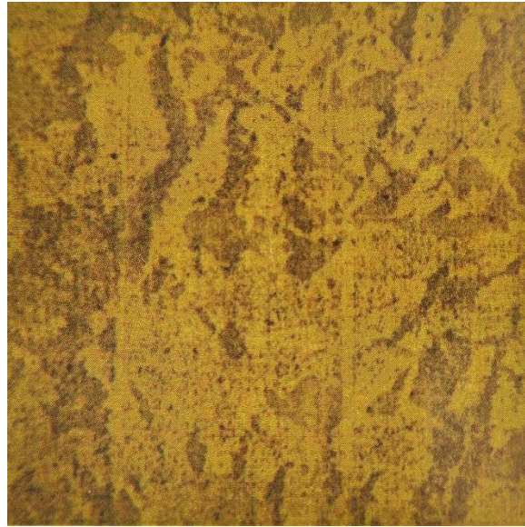
Şəkil 7.6. 13XΦA markalı boru poladının aşılammamış mikrostrukturu ×1000
