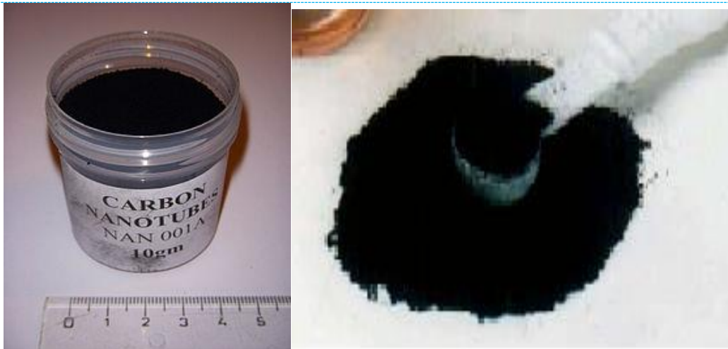
Şəkil 16. Manqanosenin və xromosenin iştirakında alınmış KNB-lər
