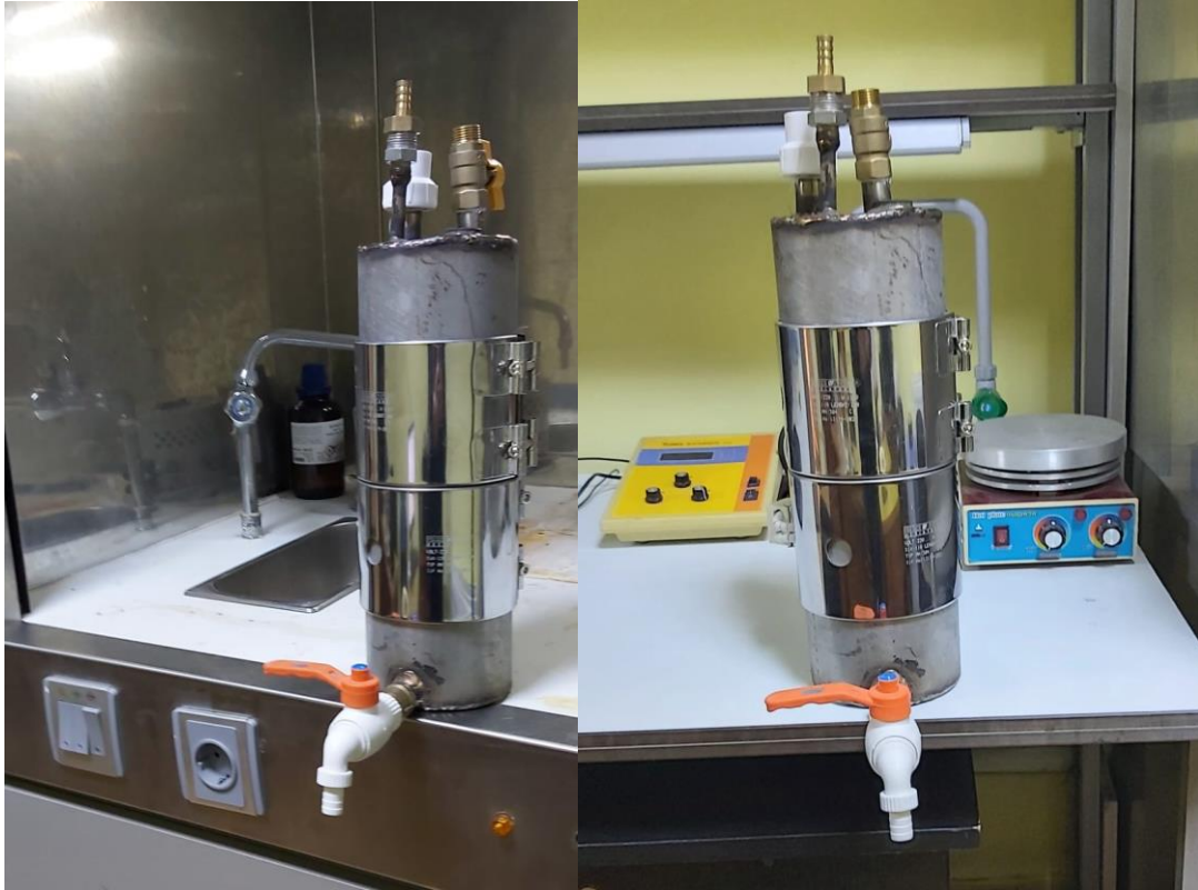
Şekil 45. Qızdırıcı ilə təchiz olunmuş oksidləşmə proseslərinin aparılması üçün dəmir reaktor.
