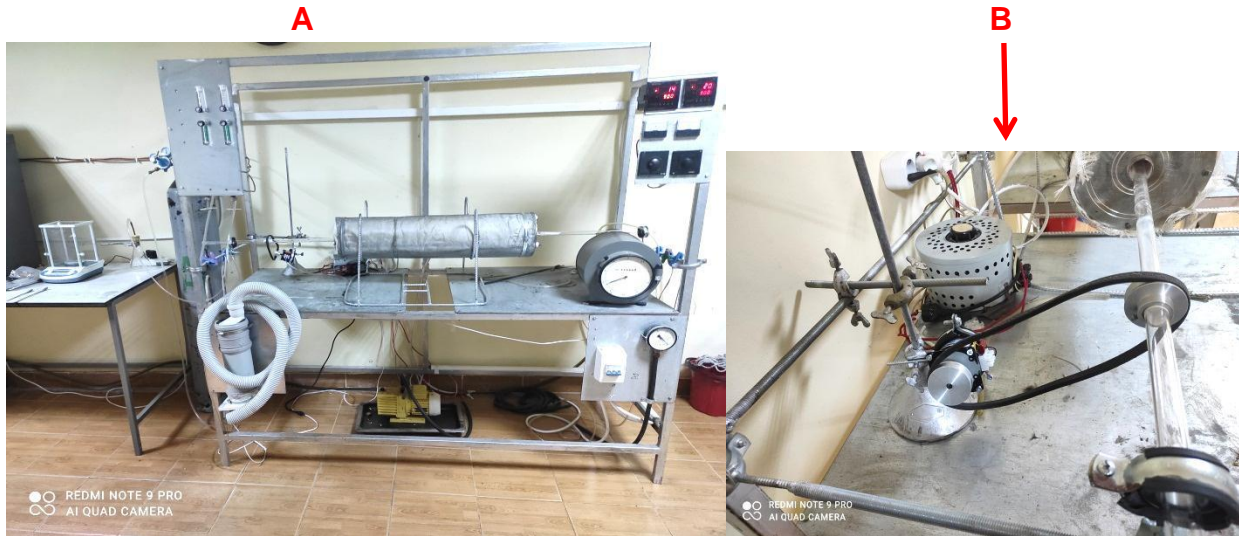
Şəkil 17. Coxdivarlı karbon nanoborularının sintezi üçün CVD pirolitik qurğusunun ümumi görünüşü (A) və kvars reaktoru fırlanma hərəkətinə gətirən cihaz (B)
